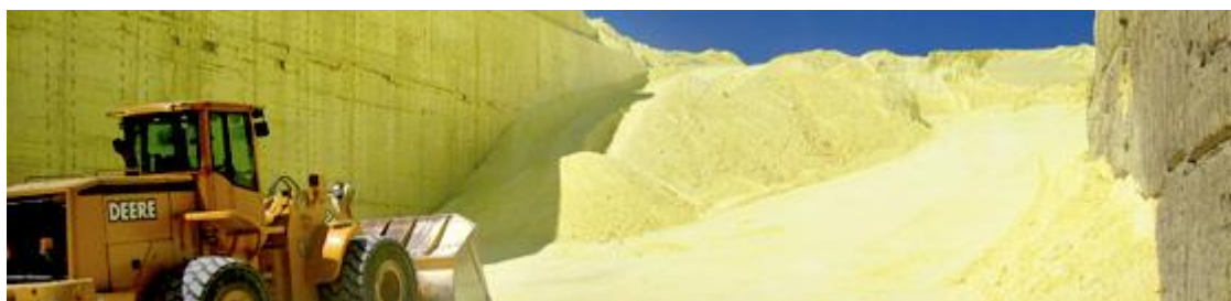
شکل (۲-۵) نحوه برداشت گوگرد از بلوک بصورت سنتی و با استفاده از لدر
