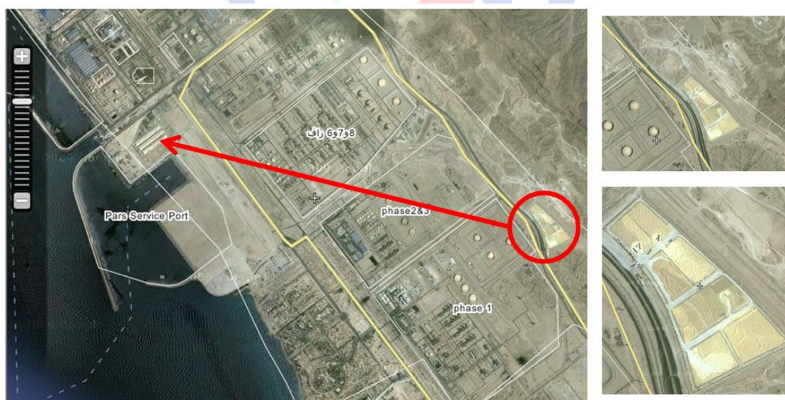
شکل (۵-۱۰) انبارش گوگرد دانه بندی شده در فضای باز منطقه پارس جنوبی
