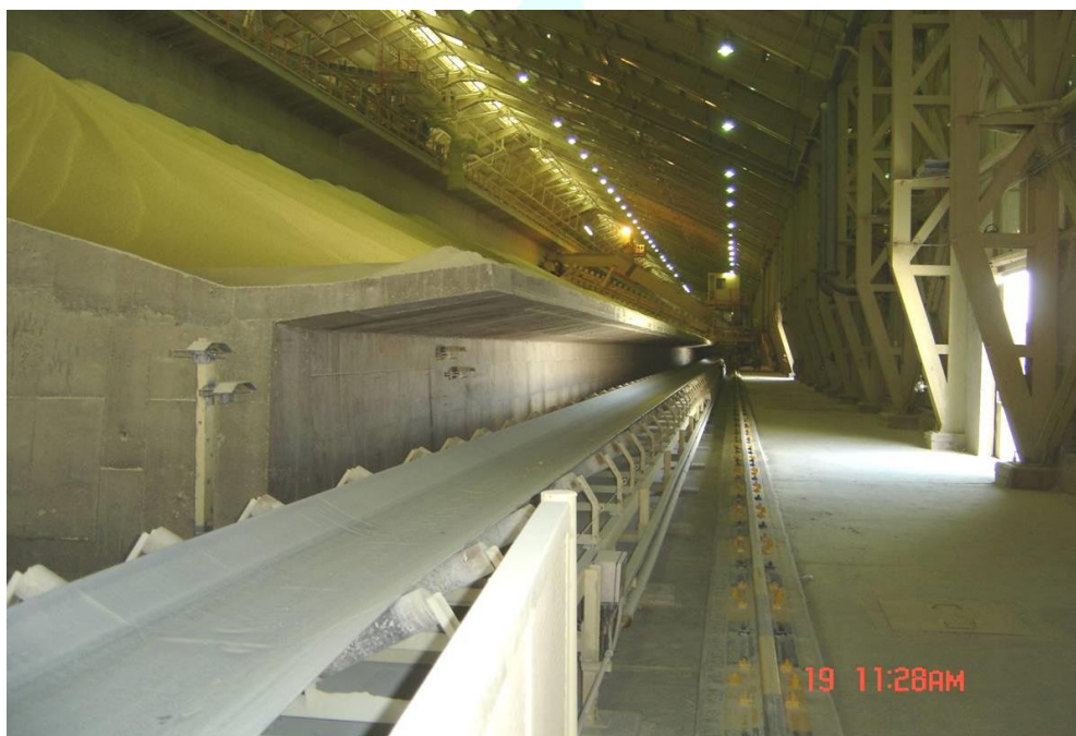
شکل (۱۱-۵) تصویری از نحوه انتقال گوگرد از انبار مکانیزه به قسمت بارگیری
