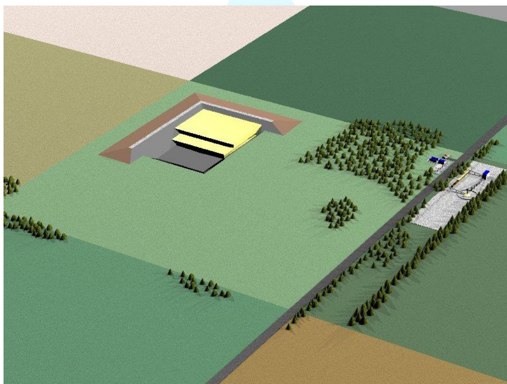
(شکل ۵-۱۳) شماتیک سه بعدی یک بخش از انبار گوگرد در زیر سطح زمین در حال پر شدن
