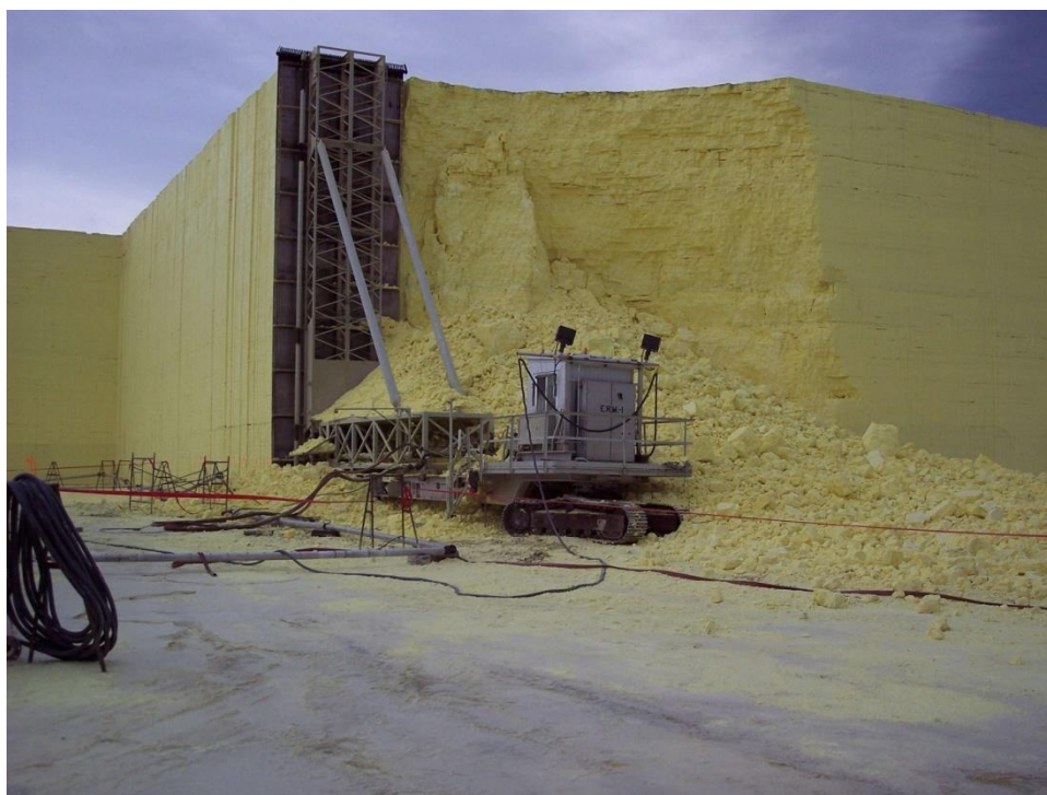
شکل (۵-۶) تصویری از ماشین آلات و جک های حرکت دهنده المنت های ذوب
