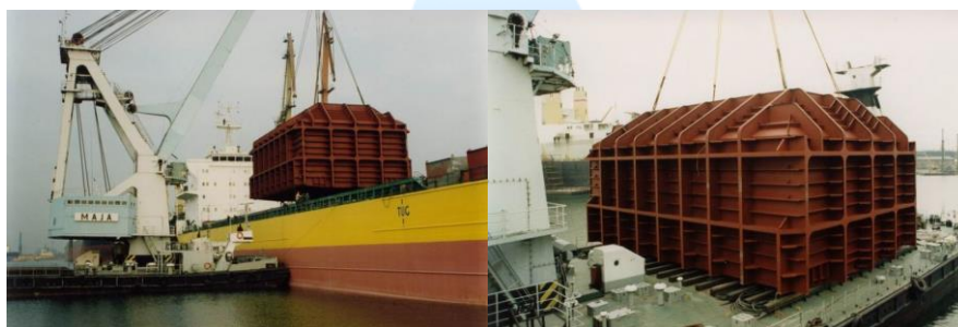
شکل (۴-۹) تصویر مخزن کشتی حمل گوگرد مذاب
