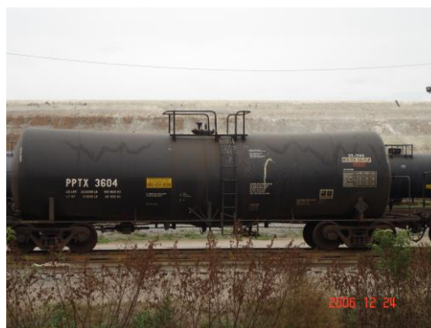
شکل (۷-۴) واگن مخصوص حمل گوگرد مذاب
