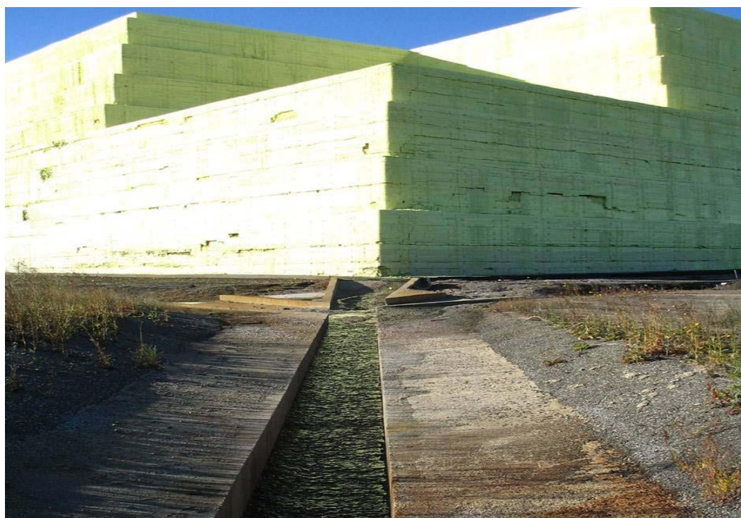
شکل (۲-۱) نمایی از انبارش گوگرد به شکل بلوک
